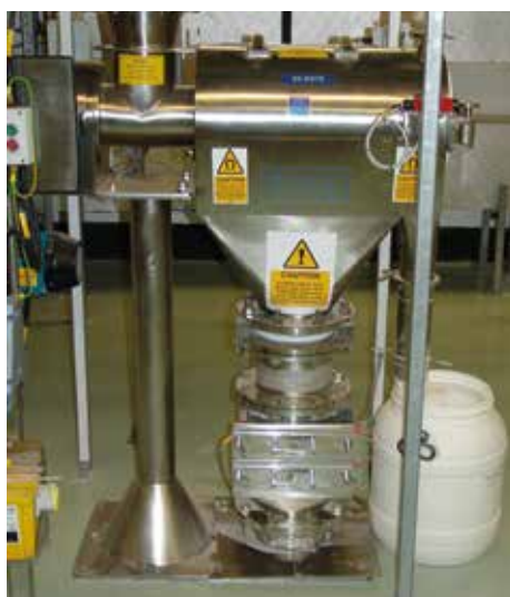
Séparateur double étages, spécialement conçu pour l'industrie pharmaceutique, avec protection avant et après crible.
